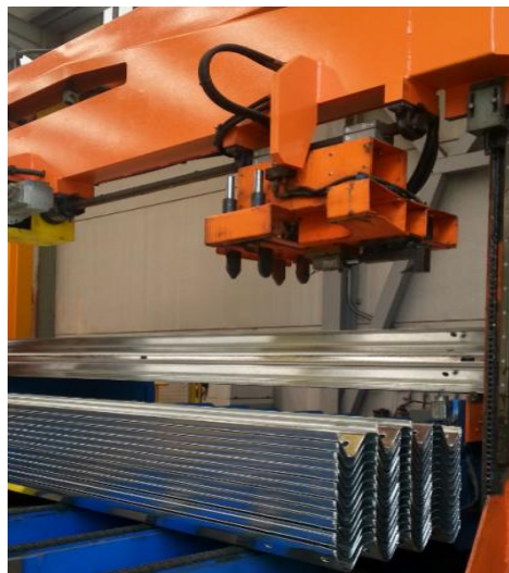
Figure 8 : Machine d'accrochage/décrochage des glissières
